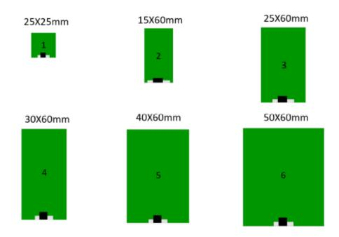
PCB ground planes: 1) 25x25, 2) 15x60, 3) 25x60, 4) 30x60, 5) 40x60, 6)50x60 All sizes in mm
